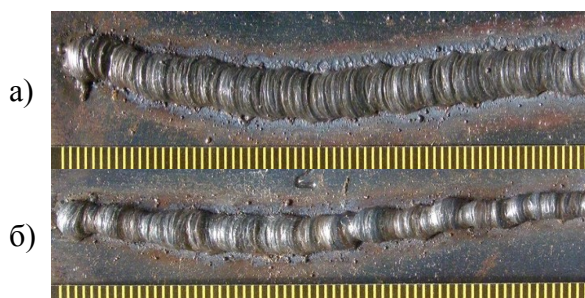
Рис. 3. Валики, наплавленные в чистом азоте на малоуглеродистую сталь толщиной 1 мм. а) I_d = 17,5 А, б) U_d = 22,5 В.
