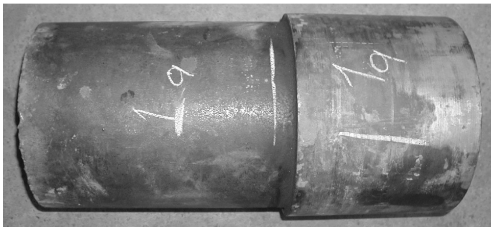
Рис. 1 Муфта и фрагмент трубы диаметром 245 мм обсадной колонны, X 0,2
