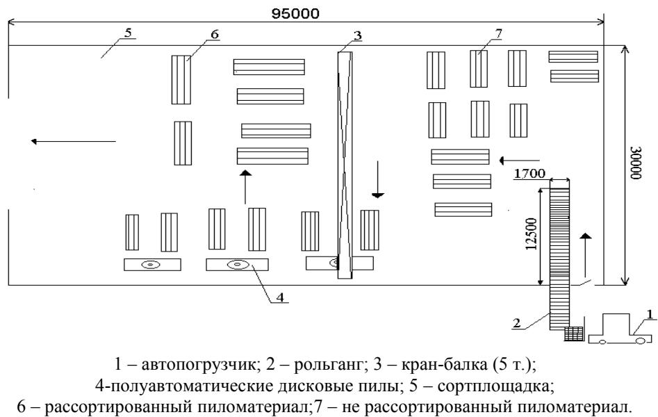
Рис. 1. Базовая схема механизации распила и сортировки пиломатериалов
