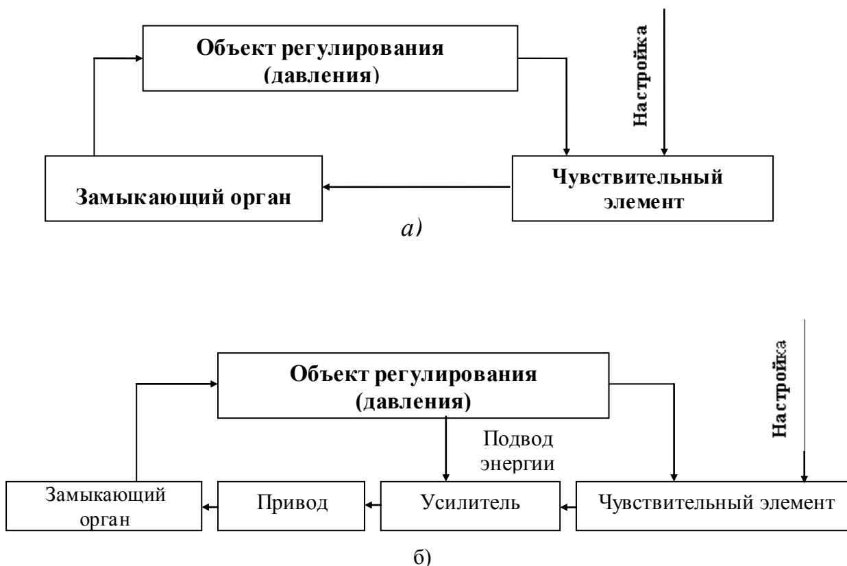
Рис.1. Структурные схемы предохранительных клапанов а) клапан прямого действия; б) клапан непрямого действия.
