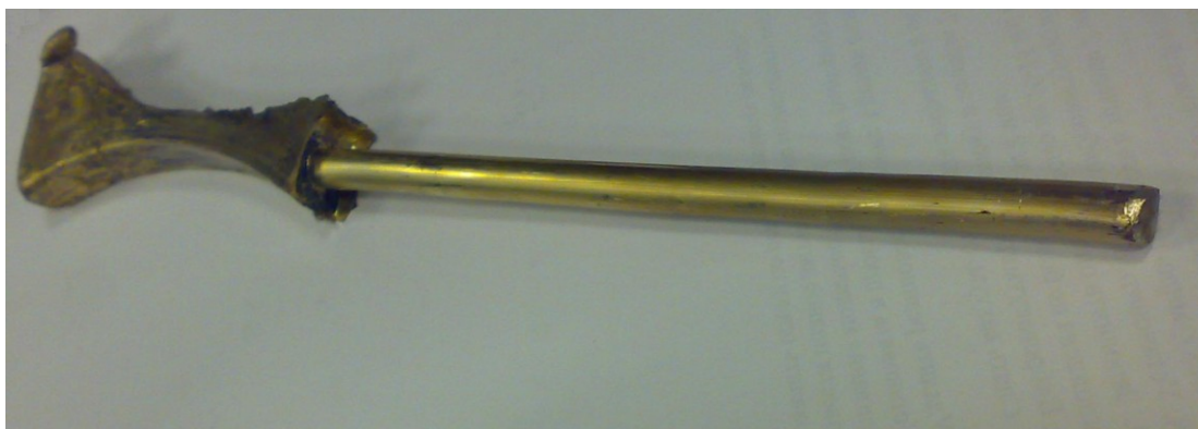
Рис. 3. Вид недоката и пресс-изделия из сплава ПСР-40
