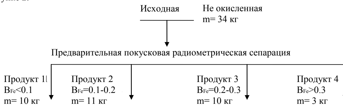
Рис. 2. Схема покусковой рентгенорадиометрической сепарации
