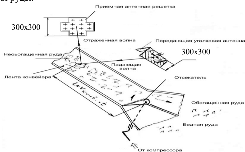
Рис. 1. Технологическая линия обогащения руды
