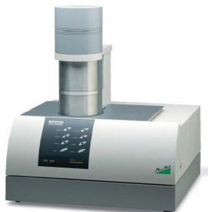
Рис. 1. Общий вид измерительной части установки «Лазерная вспышка» LFA 457
