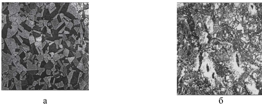
Рис. 2. Микроструктура прессованного полуфабриката из медной неотожжённой стружки с добавками: а) - 2% Pb; б) - 2% Sn, x200
