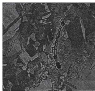
Рис. 3. Микроструктура прессованного полуфабриката из медной неотожжённой стружки с добавкой 2% порошка кремния, x200
