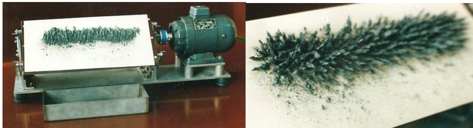
Рис. 1. Процесс сухой магнитной сепарации, полученный на сепараторе анализаторе:
