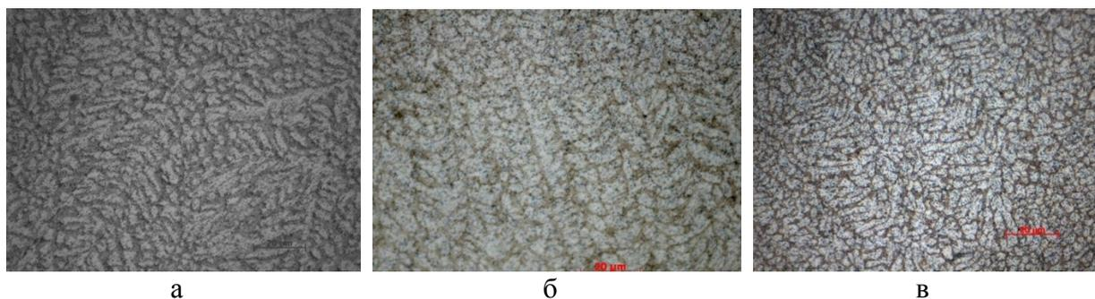
Рис. 2. Микроструктура слитков из сплава 01417, полученных со скоростью литья: а – 4,8 мм/с; б – 7 мм/с; в– 8,5 мм/с
