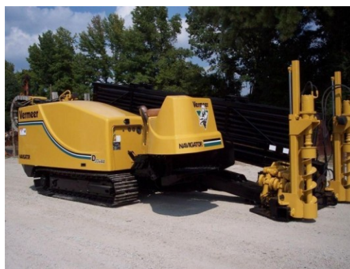
Рис. 3. Буровые установки NB70(NIPPON SHARYO), D33X44 (VERMEER)
