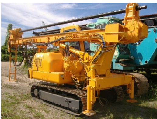
Рис. 3. Буровые установки NB70(NIPPON SHARYO), D33X44 (VERMEER)
