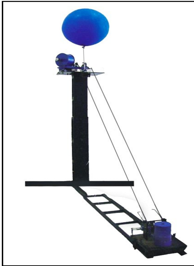
Рис. 1. Экспериментальная аэростатно-канатная гравитационная установка
