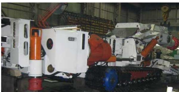
Рис. 2. Проходческий комбайн КПО-50 с приводом хода ПХ80-17
