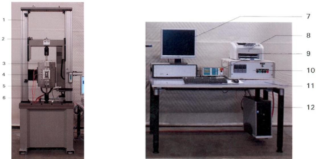
Рис. 1. Универсальная разрывная машина LFM 20 kN:
