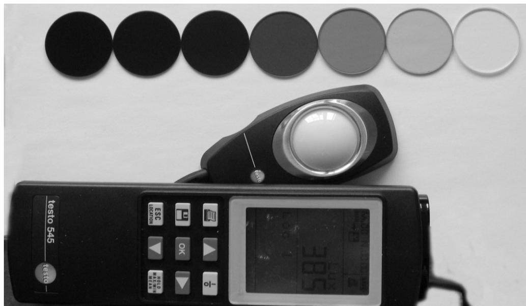
Рис. 1. Фотография разложенных калибровочных фильтров
