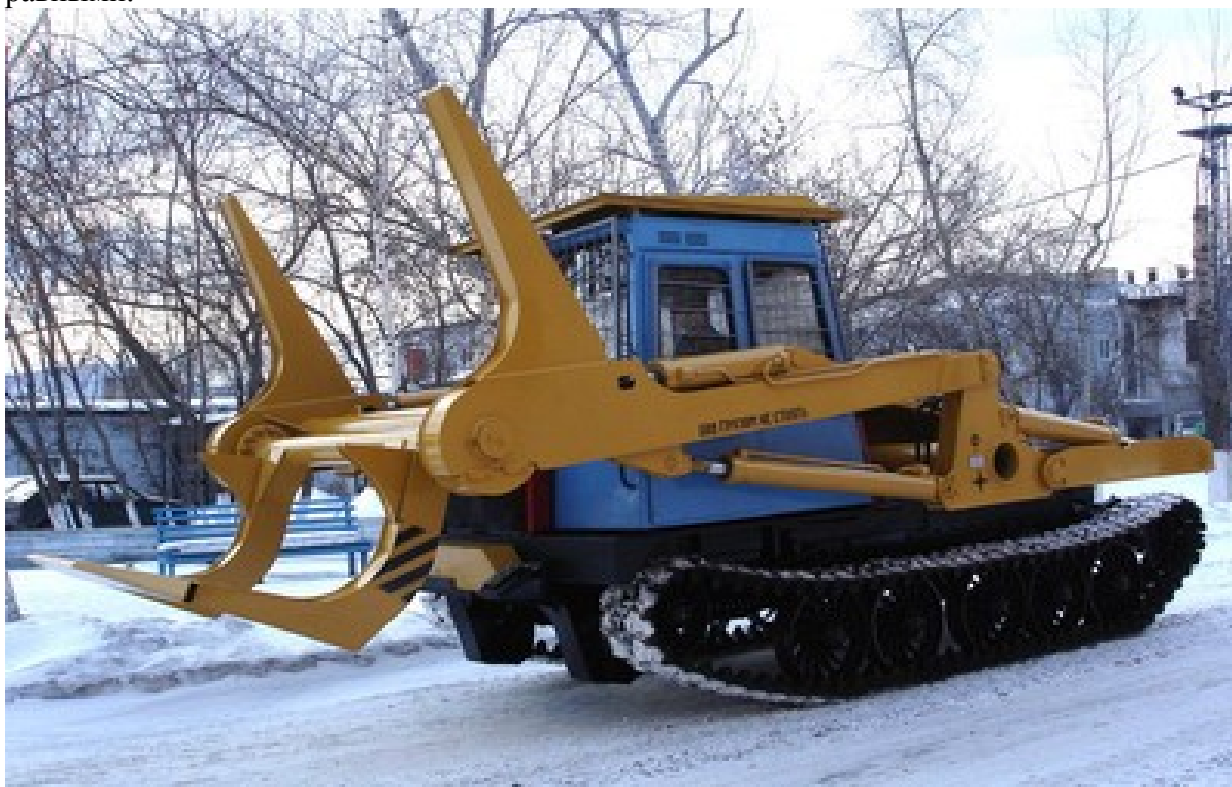
Рис. 1 – Лесопогрузчик челюстной ЛТ-188 (завод-изготовитель ОАО “Краслесмаш” г. Красноярск)
