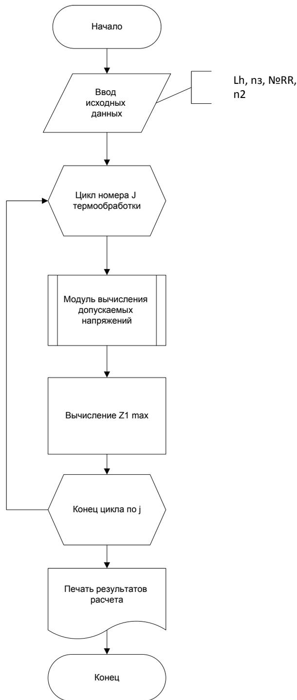
Далее, в рамках цикла, выполняется вычисление (модуль 4) допускаемых контактных и изгибных напряжений, оптимальное число зубьев шестерни (блок 5) в зависимости от ресурса, режима нагружения и передаточного отношения проектируемой передачи.
