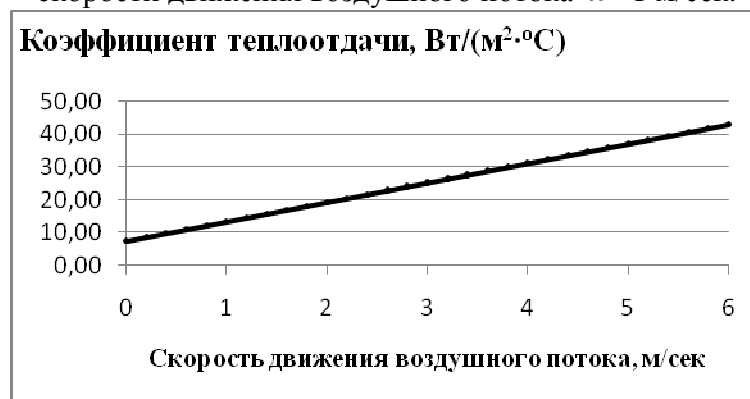
Рис. 4. Зависимость коэффициента теплоотдачи от потока воздуха к поверхности водяной пленки, в зависимости от скорости движения воздушного потока, при его влажности \phi=50\% и температуре 1 °C.
