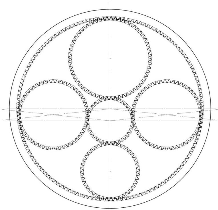
Рисунок 4 – Моделирование сборки ЭПМ при параметре  $t = 1$
