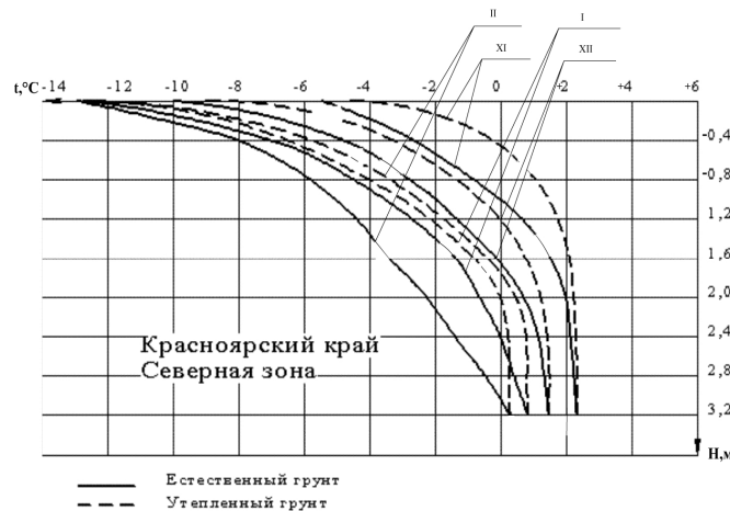
Рис. 3. Распределение температуры суглинка по глубине залегания для зимних месяцев года XI – ноябрь, XII – декабрь, I – январь, II – февраль в условиях естественного залегания грунта и утепленного карбамидным пенопластом.
