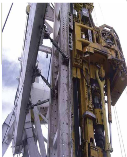
Рисунок 1 – СВП: а - Canrig (Канада), б - ПромТехИнвест (Россия)
