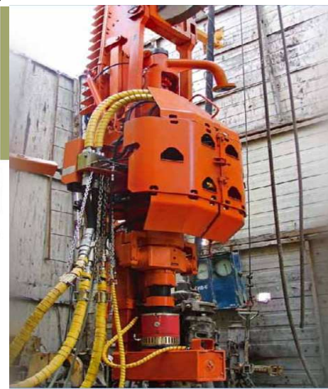
Рисунок 1 – СВП: а - Canrig (Канада), б - ПромТехИнвест (Россия)
