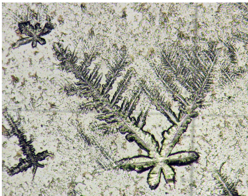
Рис.1. Дендриты монофосфата аммония под микроскопом. Ув. 100 x . Без анализатора
