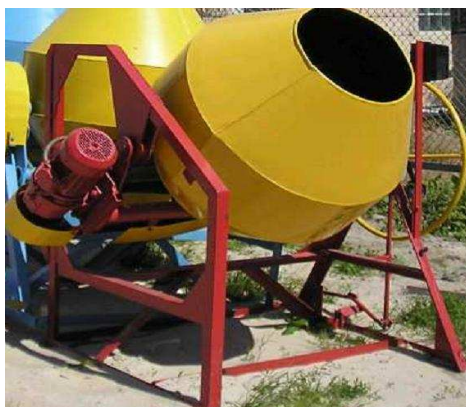
Рис. 5. Бетономешалка с червячным редуктором.
