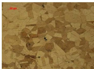
*б – после отжига прокатанной заготовки квадрат 2,1 мм ×320*
