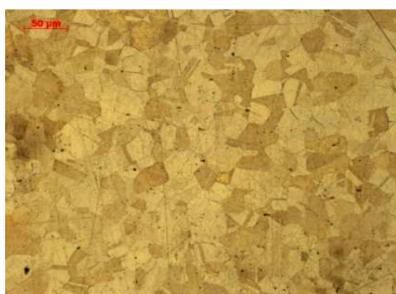
*а – после отжига прокатанной заготовки квадрат 3,7 мм ×320*
