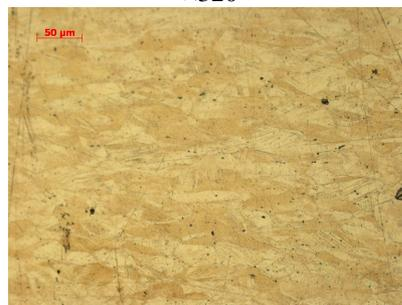
*г* - после малой степени деформации проволоки диаметром 0,9 мм, отожженной в проволоке 1,1 мм ×320
