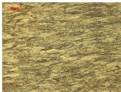
*б* - после прокатки, заготовка квадрат 2,1 мм ×320
