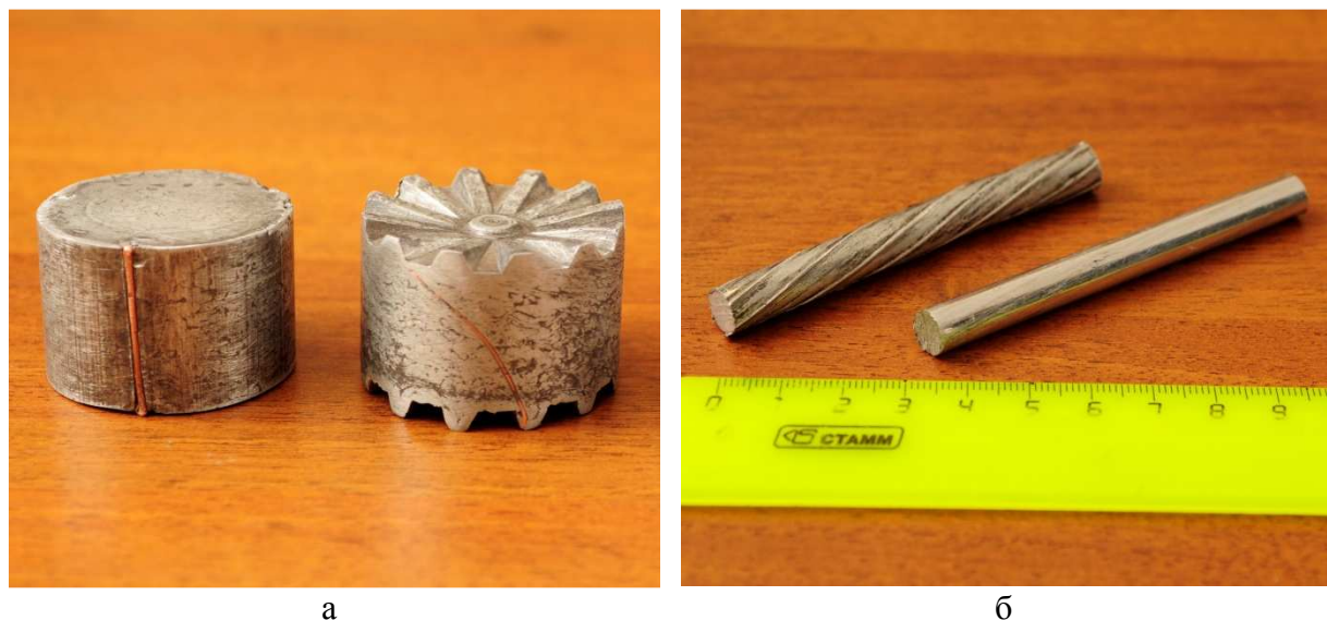
Рисунок 2 – Внешний вид брикетов (а) и экструдированных прутков (б) без наложения и с инициированием дополнительных сдвиговых деформаций
