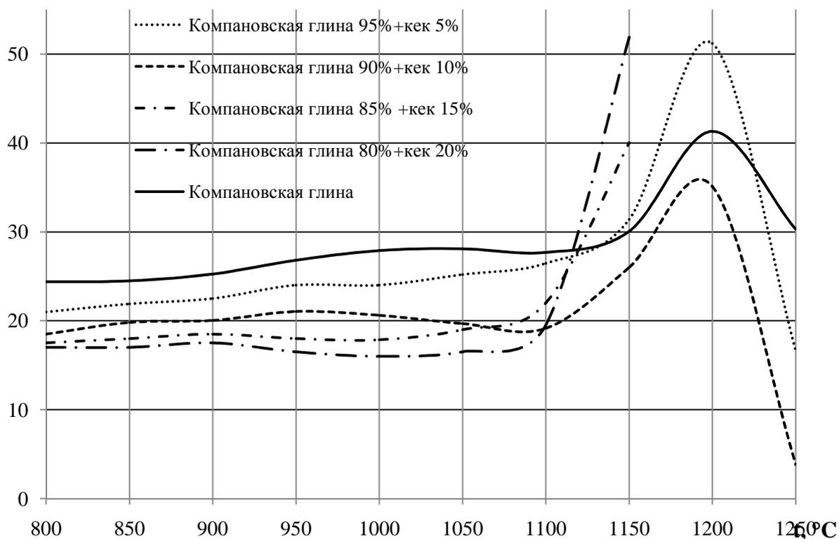
Рис. 3. График зависимость прочности при сжатии образцов от температуры обжига.
