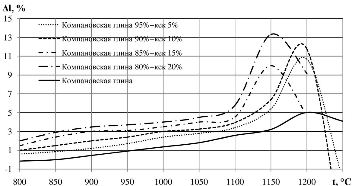
Рис.1. График зависимости огневой усадки образцов от температуры обжига.
