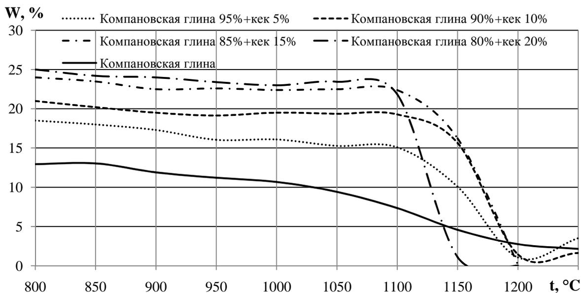
Рис.2. График зависимости водопоглощения образцов от температуры обжига.
