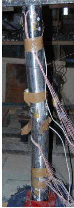
б) Разрушении колонны после второго удара.
