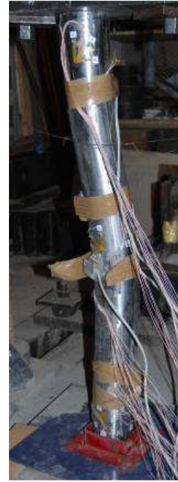
в) Разрушении колонны после третьего удара.
