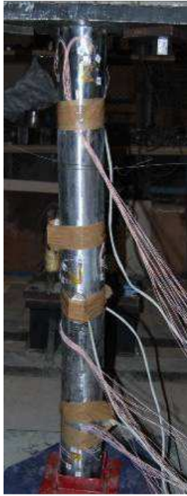
а) Разрушении колонны после первого удара.
