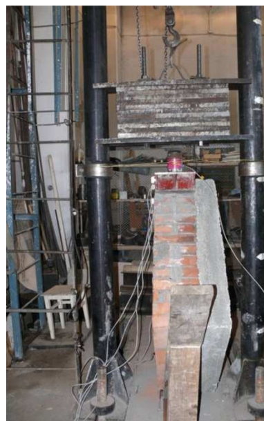
Рис. 2. Общий вид испытаний на копровой установке
