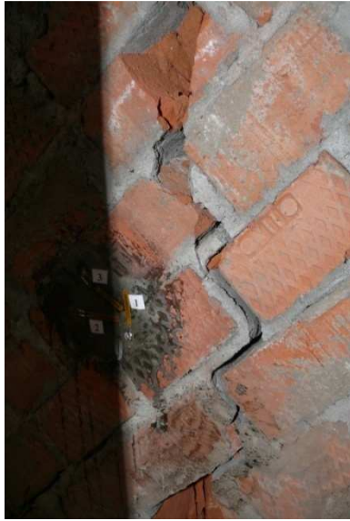
Рис. 3. Характер разрушения экспериментальных образцов
