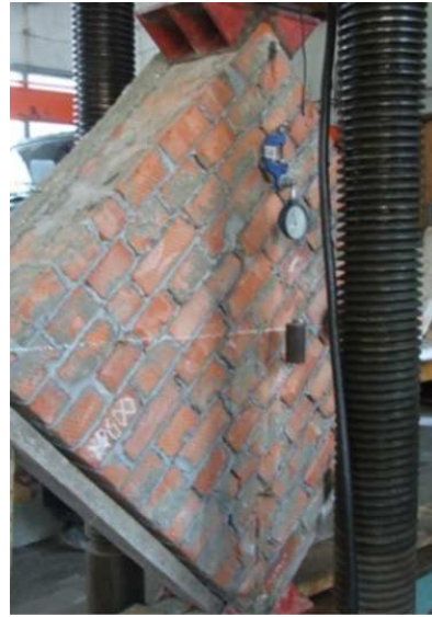
Рис. 3. Характер разрушения экспериментальных образцов
