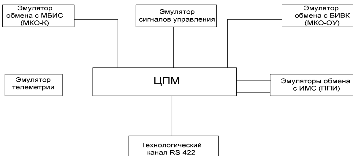
Рисунок 1. Функциональная схема НОК ЦПМ
