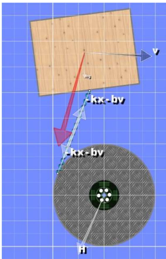
Рисунок 2. Демонстрационный пример вращательного движения. Вокруг своей оси вращается металлический диск, к которому с помощью пружины прикреплен прямоугольный предмет.
