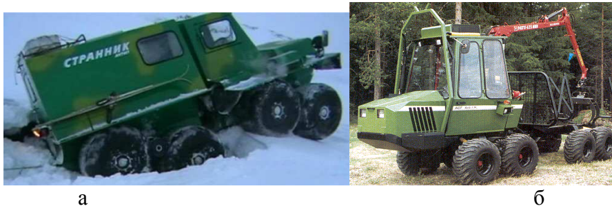
Рисунок 3 – ТС в конструкции которых используется роликовый привод колес: а – вездеход «Странник», б - мини-форвардер “AGT Rulle”
