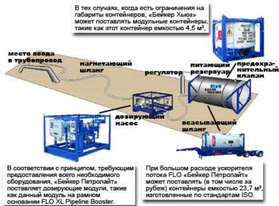
Рисунок Технологический процесс применения противотурбулентной присадки (с сайта http://www.bakerhughes.ru )
