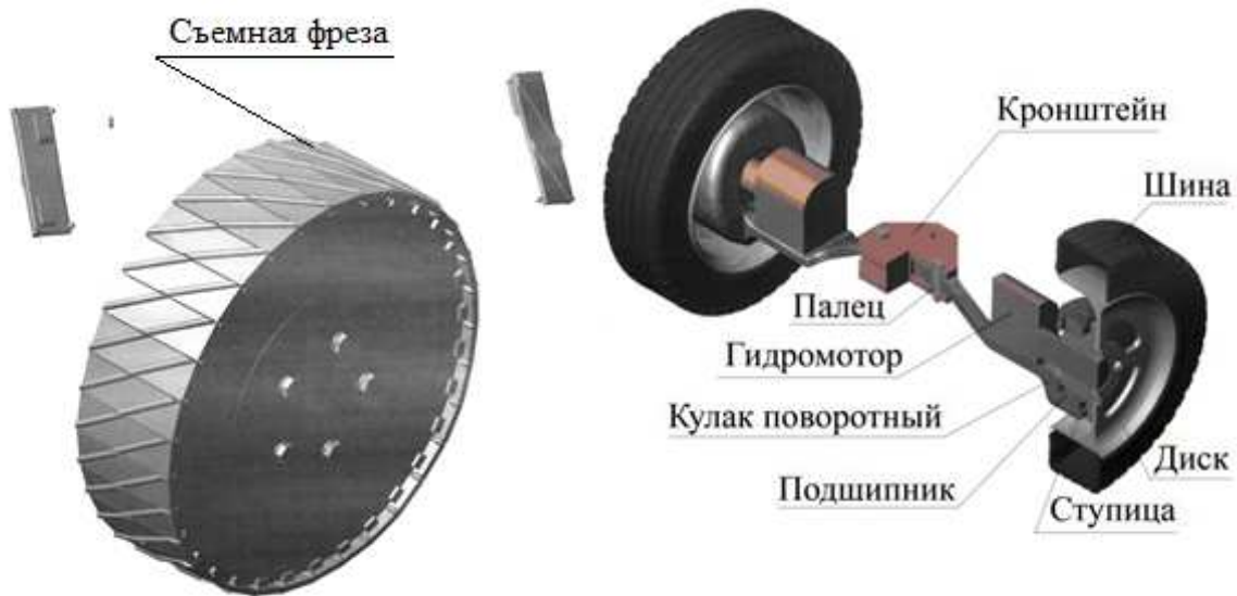
Рисунок 2 – Сменное рабочее оборудование УМП для уборки снежно-ледяных образований на дорогах
