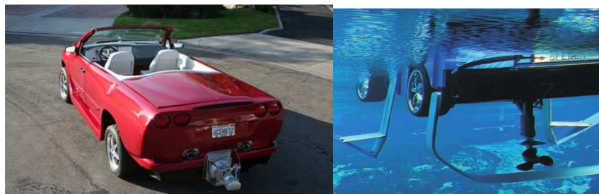
Рисунок 4. Гребной винт, водометный движители на автомобилях – амфибиях.
