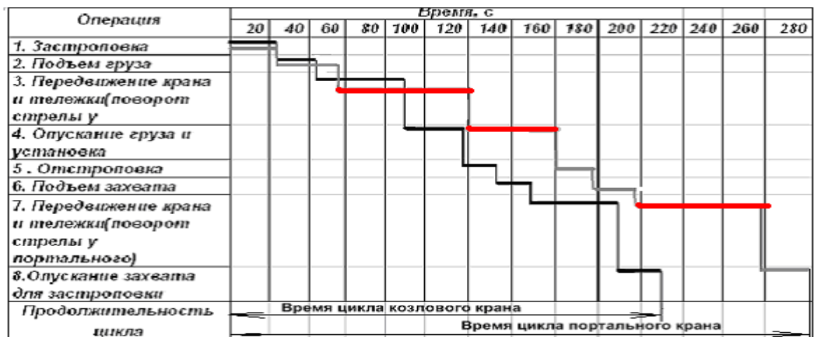
Рисунок 3. - Линейный пооперационный график работы portalного и козлового кранов в проектном варианте.
