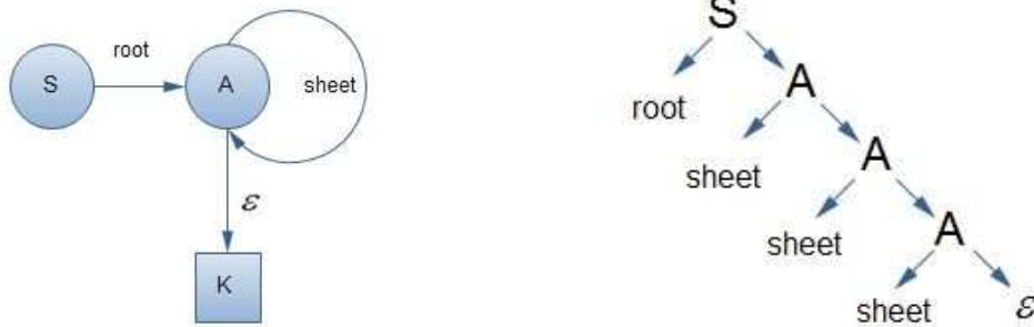
Рис. 2. Граф автоматной грамматики вывода цепочек повтора Chain (слева) и дерево вывода этих цепочек (справа)
