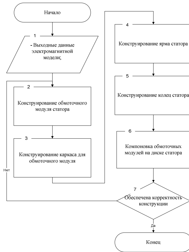
Рисунок 3 – Алгоритм конструирования статора
