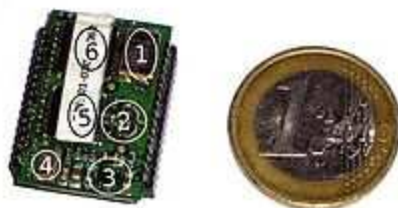
Рисунок 1 - Модуль ZigBee (слева) и монета в 1 евро (справа) диаметром в 23 мм для сравнения размеров
