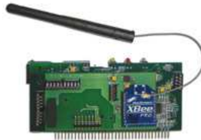
Рисунок 4 - Управляющий контроллер с интегрированным ZigBee-модулем
