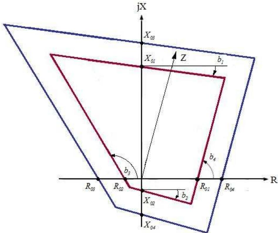
Рис. 2 - Характеристика срабатывания блокировки при качаниях
