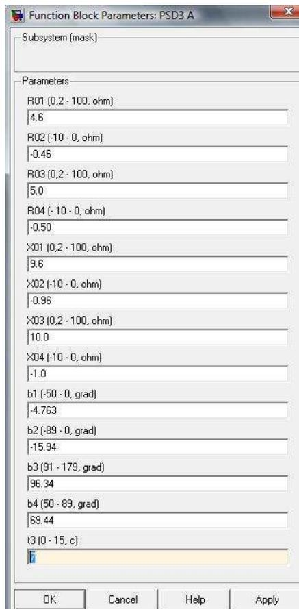
Рис. 3 – Уставки органа блокировки при качаниях
