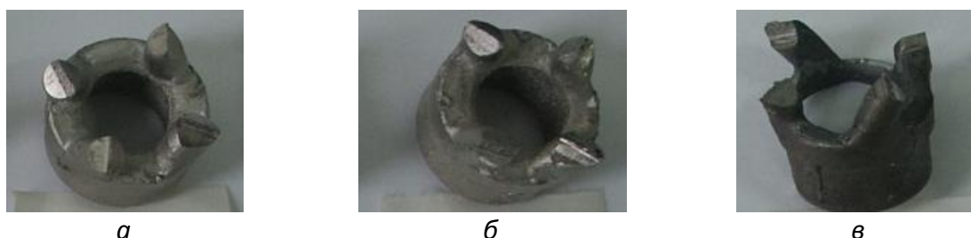
а – без Cu; б – менее 5 % (масс.) Cu; в – более 5 % (масс.) Cu Рис. 1. Отливки палладиевых сплавов 850 пробы системы Pd-Ag
