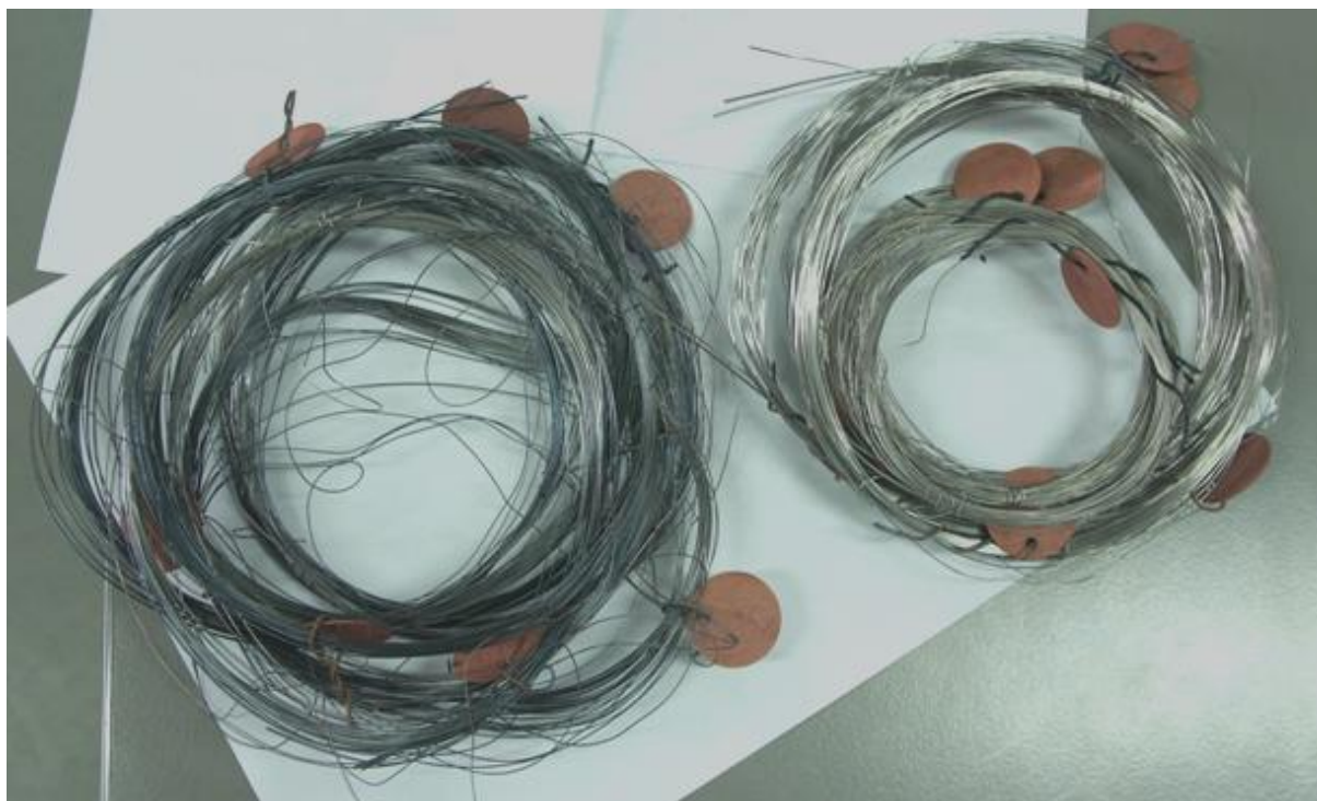
Рис. 3. Деформированные полуфабрикаты сплавов палладия системы Pd-Ag с различным содержанием меди после отжига
