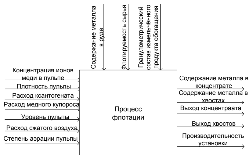
Рисунок 1 – Процесс флотации как объект автоматизации
