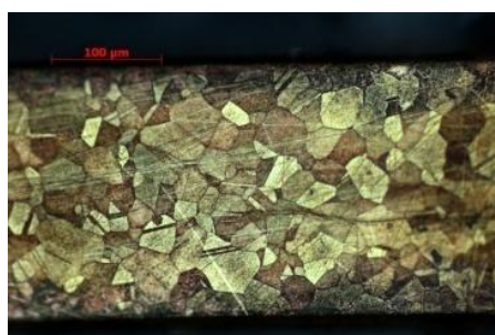
Рисунок 2 – Микроструктура проволоки, диаметром 0,3мм в отожженном состоянии
