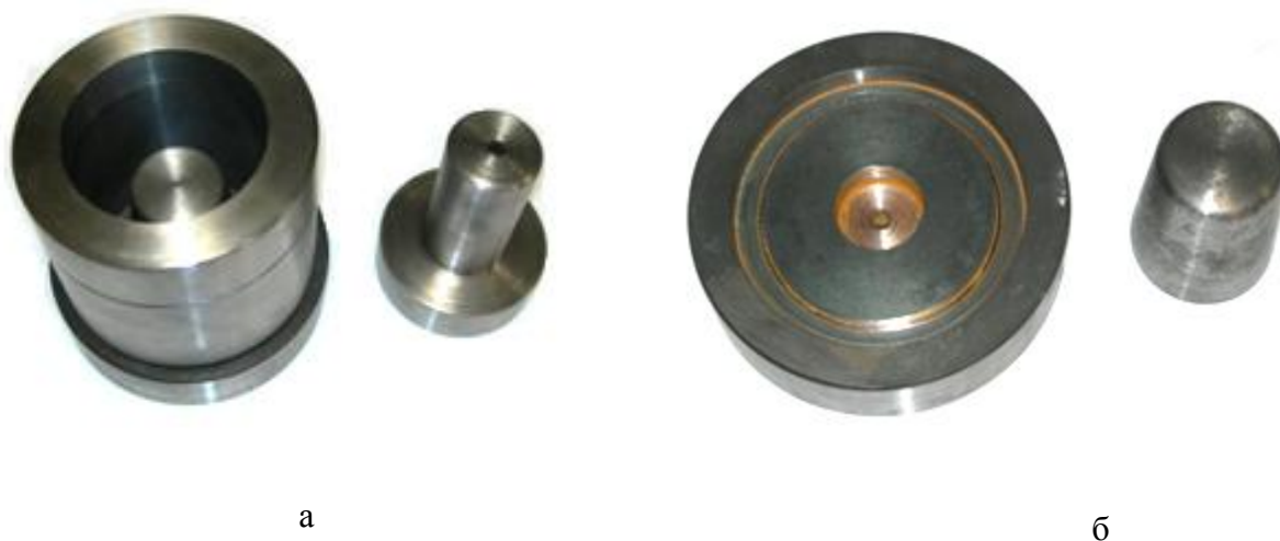
Рис. 2 – Пресс-матрица (а) и стержень (б) для изготовления тиглей
