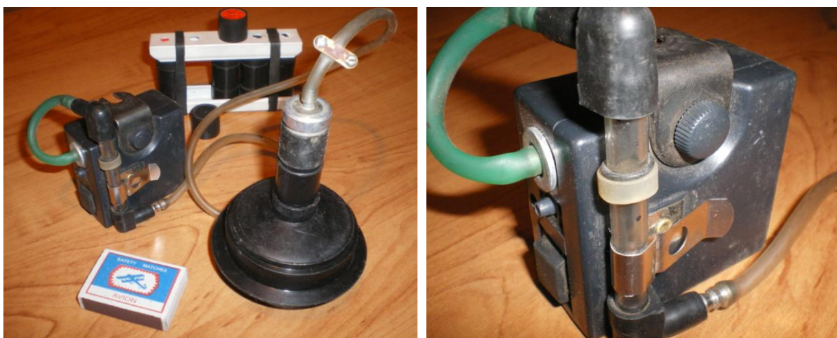
Рис. 3. Общий вид установки, адаптированной для экспрессного пробоотбора почвенного воздуха с поверхности грунта (слева) и внешний вид воздуходувки модели 301 Sonic Battery air pump после модернизации (справа).
