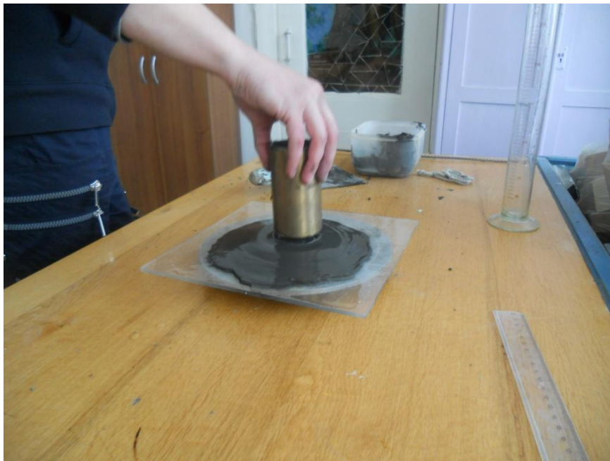
Рис. 3. Испытания на расплыв закладочной смеси
