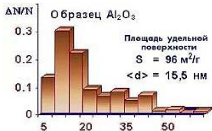
Рисунок 5 – Распределение по размерам частиц оксида алюминия электровзрывного синтеза, используемого в качестве модификатора
