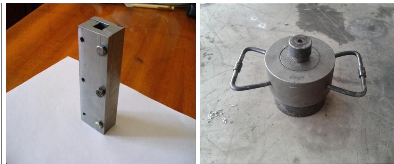
Рисунок 3 – Кокиль для литья призматических образцов слева и пресс-форма для изготовления модифицирующих прутков справа
