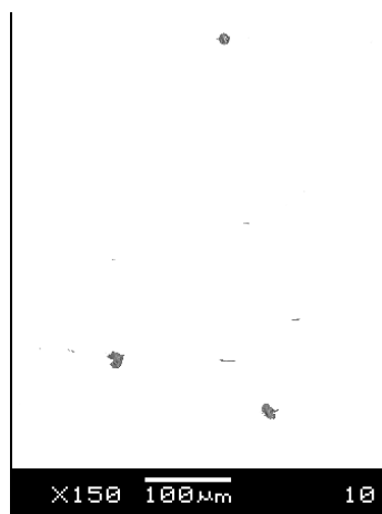
Рисунок 4 – Внешний вид скопления неметаллических глобулярных включений, 2 заготовка от 3 ручья.
