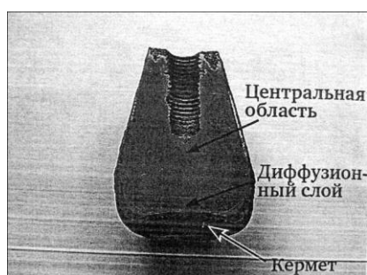
Рисунок 2 – Капсулированный анод (металлическая сердцевина Ni – 6% Al – 10% Cu – 11% Fe – 3% Zn, полученная СВС-спеканием, керметное покрытие 17% Cu – 65% \text{NiFe}_2\text{O}_4 – 18% NiO, нанесенное плазменным напылением) после электролиза.
