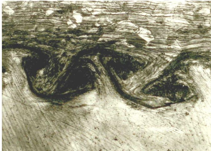
Рисунок 2 – Микроструктура, полученная в оптическом микроскопе от участка сварного шва.
